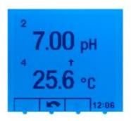
Hier wurde im Menü Formatauswahl die Anzeige für 2 Sensoren ausgewählt. Des weiteren wurden im Menü Anzeigemodus die Sensoren 2 + 4 zur Anzeige ausgewählt. Der Pfeil nach oben zeigt eine Regelung der Temperatur nach oben an, folglich ist die Heizung im Moment aktiv.
