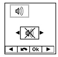
In diesem Menü werden der Tastenton <u>und</u> der Akustische Alarm aktiviert/deaktiviert. Benutzen Sie zur Einstellung die Taste ◀ oder ▶ . Um die Einstellung zu speichern bestätigen Sie mit der Taste **Ok** . Danach befinden Sie sich wieder im Hauptmenü.
