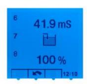
Hier wurde im Menü Formatauswahl die Anzeige für 3 Sensoren ausgewählt. Des weiteren wurden im Menü Anzeigemodus die Sensoren 6 + 7 + 8 zur Anzeige ausgewählt. Sensor 7 zeigt symbolisch ein Pegel Modul an, der Sensor zeigt momentan "Wasser" an.
