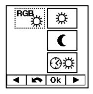
Das RGB Menü besitzt drei Untermenüs. Bei den ersten zwei wird die Farbe und Helligkeit der Hintergrundbeleuchtung für den Tag und für die Nacht entsprechend der Symbole eingestellt. Benutzen Sie zur Einstellung der Farben die Tasten . Bestätigen Sie die Einstellung jeder Farbe mit **Ok** um zur nächsten Farbe zu wechseln. Um die Einstellungen zu speichern und das Untermenü zu verlassen drücken Sie die Taste .
