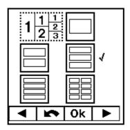
In diesem Menü können Sie einstellen, wie viele Messwerte gleichzeitig angezeigt werden sollen. Die Möglichkeit 1,2,3,4 oder 8 Sensoren gleichzeitig anzuzeigen stehen zur Verfügung. Zur Auswahl springen Sie mit Hilfe der Tasten ◀ oder ▶ zu dem gewünschten Format und bestätigen Sie dieses mit der Taste Ok. Es erscheint nun ein ✓ hinter dem gewünschten Format. Um die Einstellung zu speichern drücken Sie die Taste ▶ Nun befinden Sie sich wieder im Hauptmenü.
